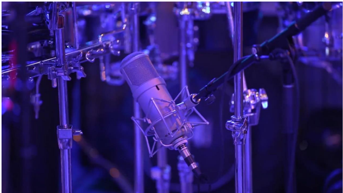
Εικόνα 21: Atlantis FC-387, μικρόφωνο κάτω από το δευτέρου σετ κρουστών (Puremix, 2022)
