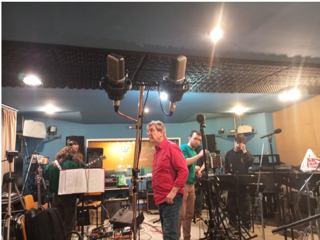
Εικόνα 49: Μικρόφωνα Overhead με τοποθέτηση ORTF: (AKG C214)
