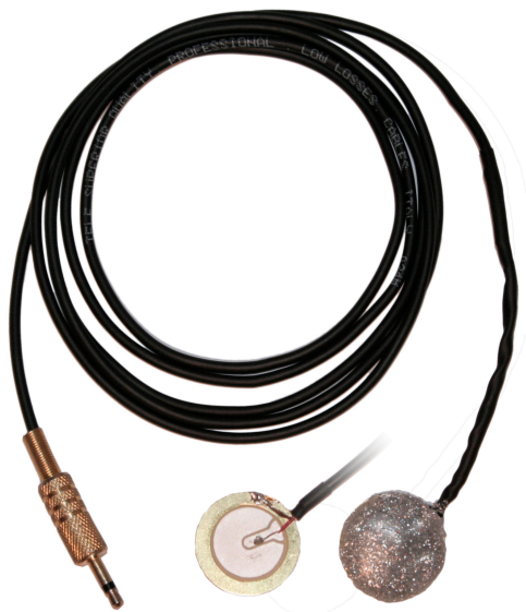
Εικόνα 23. Κάτοψη όπου φαίνεται η ένωση του σπλισμένου καλωδίου με τον πιεζοηλεκτρικό δίσκο (αριστερά) και η επικάλυψη σιλικόνης με στρας (δεξιά) (φωτογραφία Κ. Βελένης).
