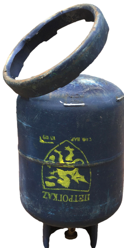
Εικόνα 14. Όψη της φιάλης όπου φαίνεται ενδεικτικά η αφαίρεση της βάσης (φωτογραφία Κ. Βελήνης).
