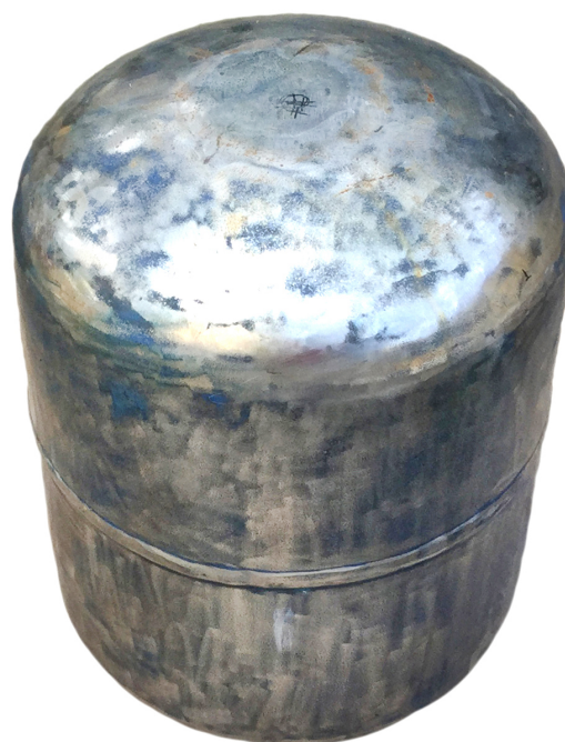
Εικόνα 15. Όψη της φιάλης όπου φαίνεται το μεταλλικό σώμα της μετά την αφαίρεση του χρώματός της (φωτογραφία Κ. Βελένης).
