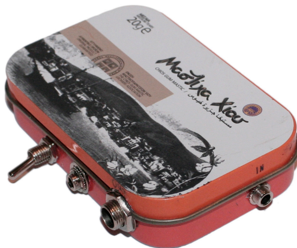
Εικόνα 25. Επανάχρηση κουτιού μαστιχών ως θήκη του κυκλώματος του προενισχυτή (φωτογραφία Κ. Βελένης).
