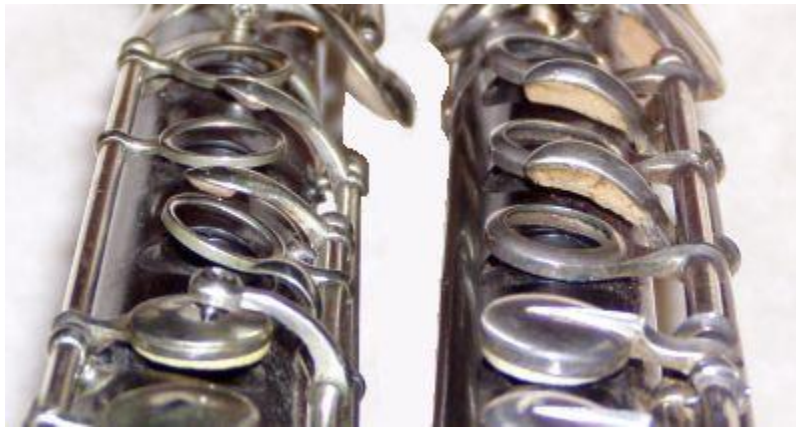
Εικόνα 3.5.2 αριστερά: ράβδοι-άξονες και από τις δύο πλευρές του οργάνου, δεξιά: ράβδοι-άξονες μόνο από την εσωτερική πλευρά του οργάνου.
