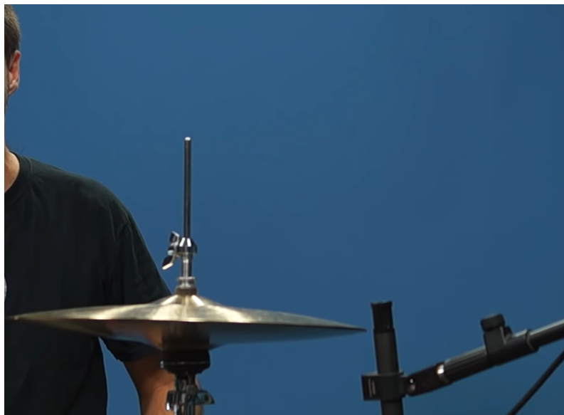
Εικόνα 18. Λανθασμένη τοποθέτηση μικροφώνου στο χάλι χατ 4 .
