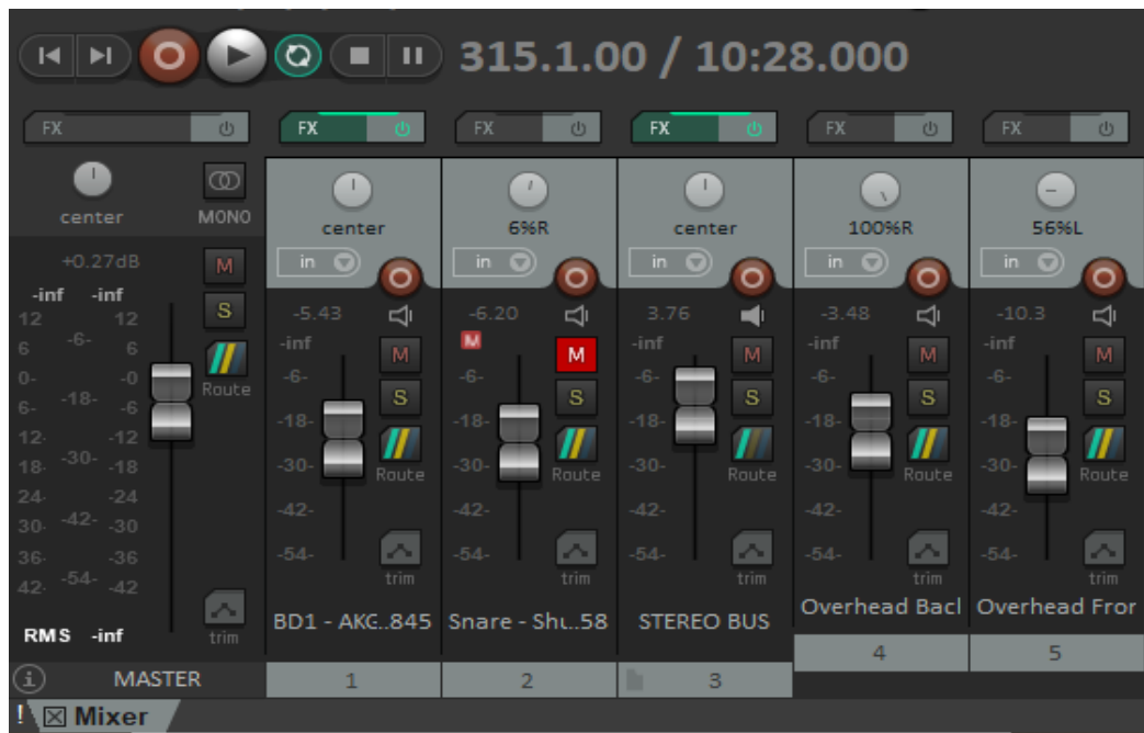
Εικόνα 75. Στάθμες και panning των καναλιών της Recorderman technique.
