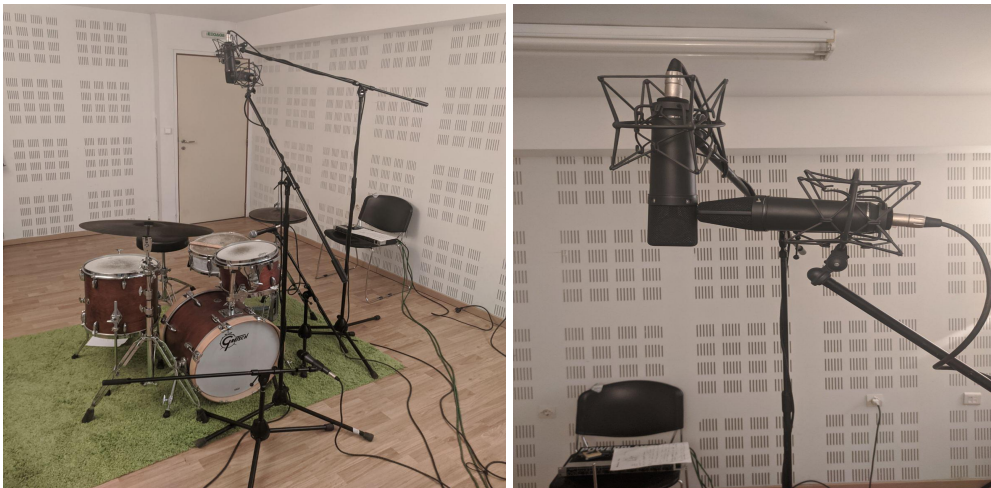
Εικόνα 46. Τοποθέτηση μικροφώνων για την M/S technique.
