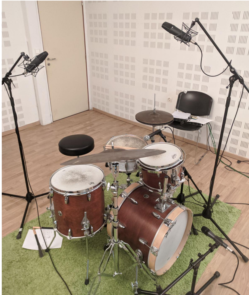
Εικόνα 50. Τοποθέτηση μικροφώνων για την Recorderman technique.
