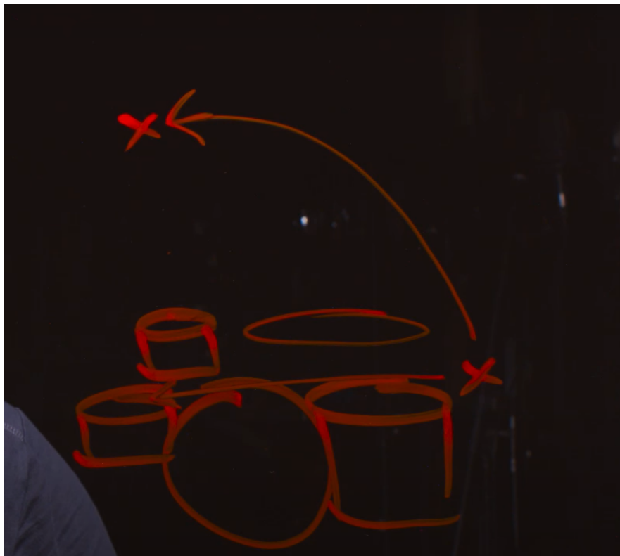
Εικόνα 33. Διαφορετική μεθοδολογία τοποθέτησης μικροφώνων για την Glyn Johns technique. Πηγή: https://www.youtube.com/watch?v=47zniukCjTo&t=441s
