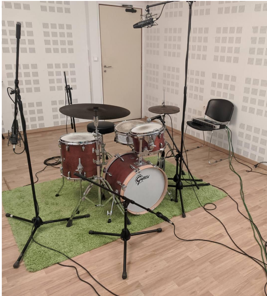
Εικόνα 48. Τοποθέτηση μικροφώνων για την τεχνική Glyn Johns
