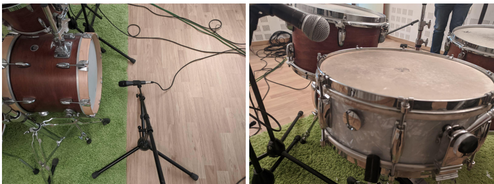
Εικόνα 51. Τοποθέτηση μικροφώνου κοντινής λήψης (close-mic) στη μπότα (αριστερά) και στο ταμπούρο (δεξιά)
