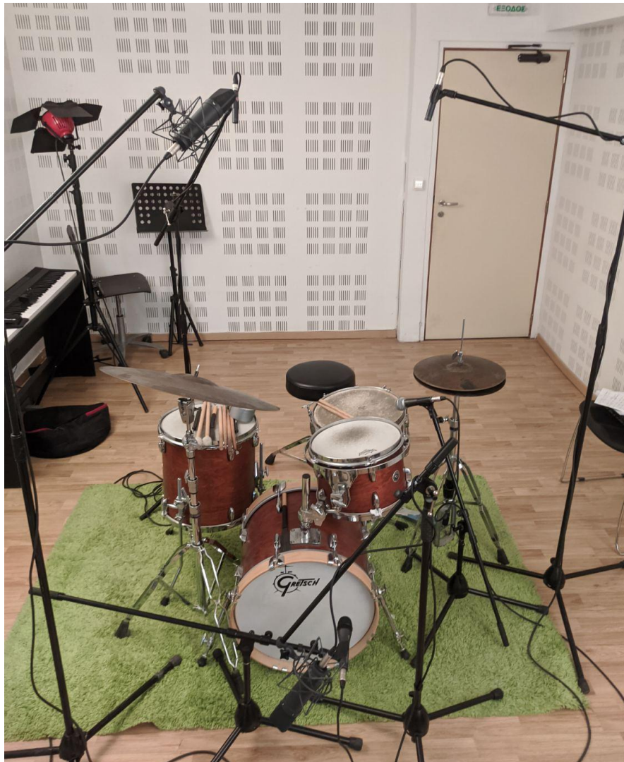
Εικόνα 49. Τοποθέτηση μικροφώνων για την Weathervane method.
