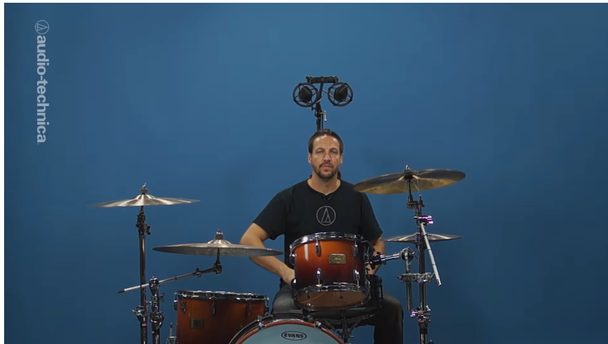
Εικόνα 26. Τα μικρόφωνα της ORTF βρίσκονται πίσω από τον εκτελεστή “κοιτάζοντας” προς τα μπροστά. Πηγή: https://www.youtube.com/watch?v=q2ccgv4jaiE&list=LL&index=59&t=135s
