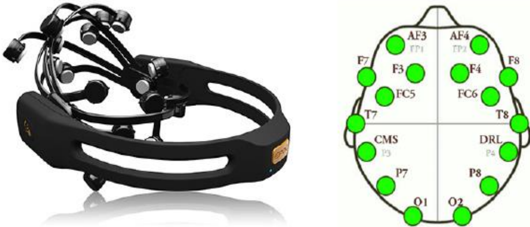
Εικόνα 15. Στα αριστερά είναι μία μη επεμβατική συσκευή EEG. Δεξιά οι θέσεις ηλεκτροδίων στο τριχωτό της κεφαλής μέσω του Emotiv application. (Προσαρμογή από 16 ).
