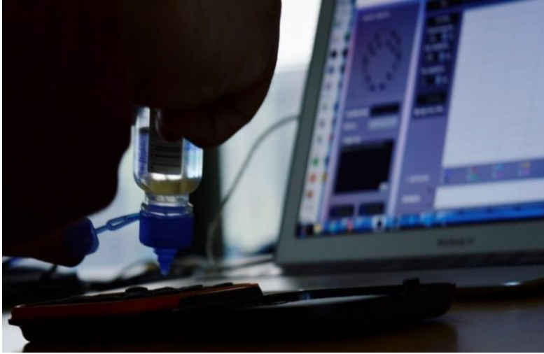
Εικόνα 45. Υγραση wet ηλεκτροδίων με υγρό φακών επαφής για καλύτερη αγωγιμότητα με το τριχωτό της κεφαλής.
