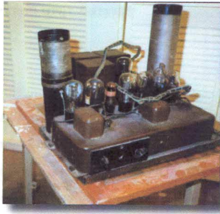
Εικόνες 2.2, 2.3, 2.4: Το εσωτερικό του theremin με τις λυχνίες και τα δύο πηνία για τις κεραίες (Chadabe, 1997).
